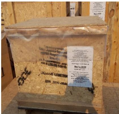
Рисунок 4. Пример упаковки с использованием полиэтиленовой пленки
