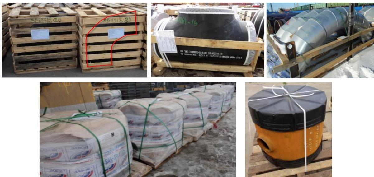
Рисунок 22. Пример упаковки фасонных изделий, деталей трубопроводов
