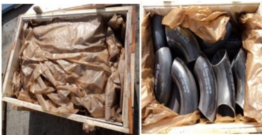
Рисунок 21. Пример упаковки фасонных изделий, деталей трубопроводов
