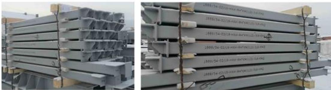
Рисунок 8. Пример пакетирования металлоконструкций с нанесенным защитным слоем
